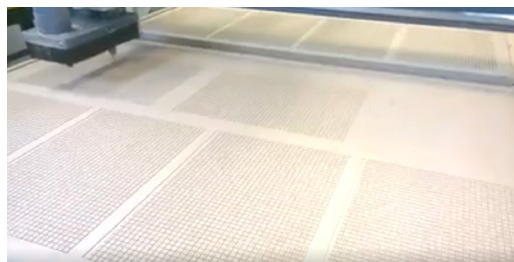
12 platen uitfrezen en bijna 6000 gaten boren
